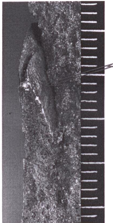
Şəkil 4. Kövrək uzununa çatın dağılma ocağı sahəsində açılmış metallurji yayma batığı
