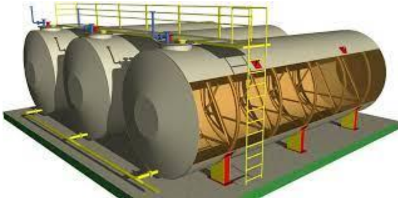
Şəkil 1. Neft məhsullarının nəqlində geniş istifadə edilən rezervuarların nümunəsi.
