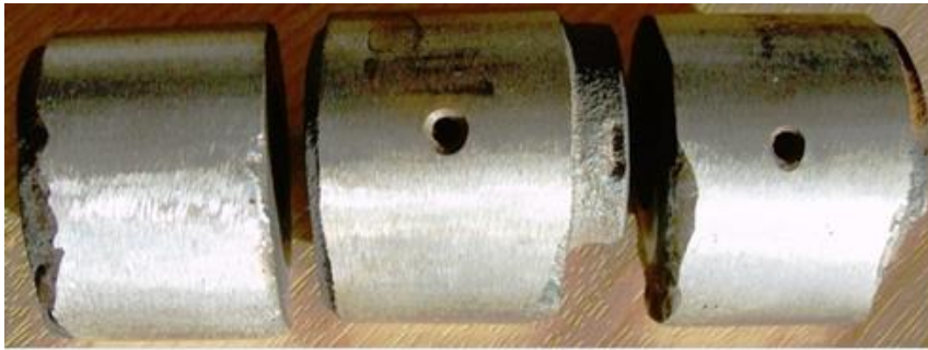
Şəkil 3. Adi TİG üsulu ilə səthlərinə örtük çəkilmiş yumruq və linglərdə baş vermiş qüsurlar.
