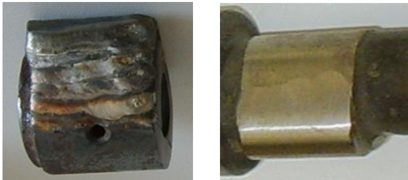
Şəkil 4. Yüksək tezlikli maqnit sahəsində TİG- üsulu ilə səthi yenidən əridilmiş və üstəridilmiş yumruqların ümumi görünüşü.
